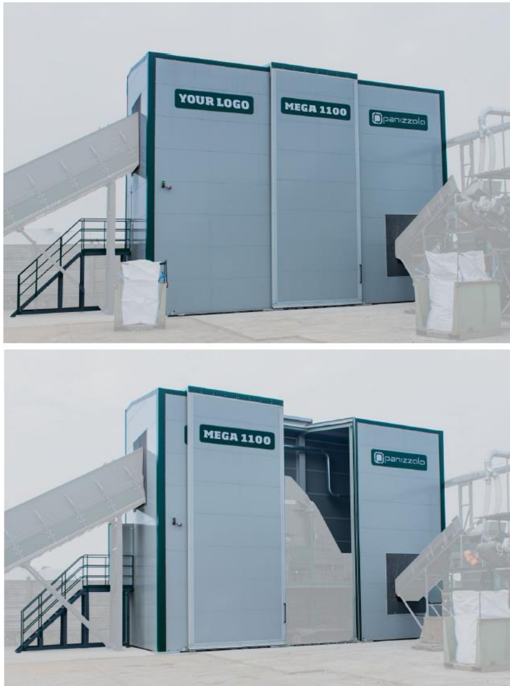
Enceinte d'isolation acoustique du broyeur
